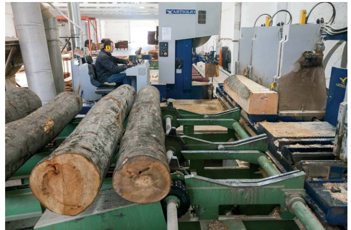
Распиловка бревен на производительной итальянской пилораме.
