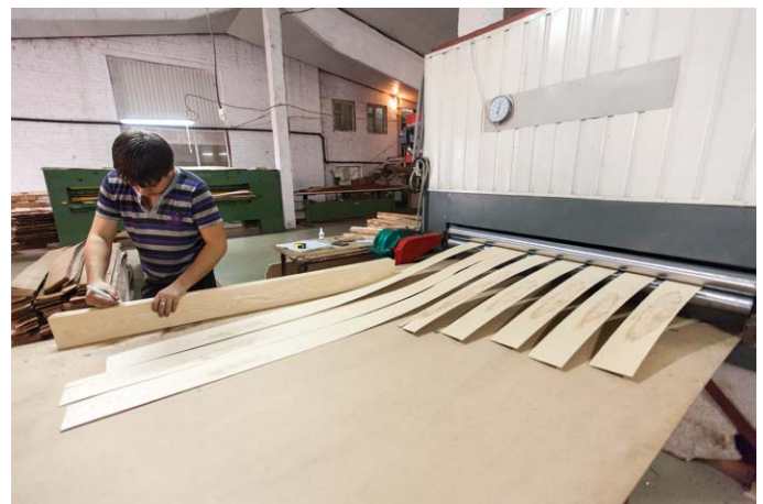
Строгание и сушка шпона на японском оборудовании.
