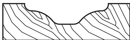
№4 ширина 36 мм; глубина 9 мм.
