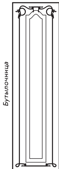
Ящик с полноценной фрезеровкой
