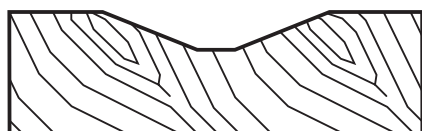
№3 ширина 30 мм; глубина 5 мм.
