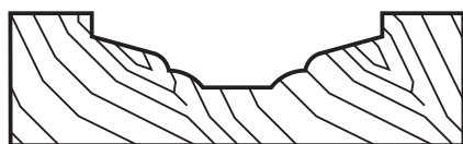
№2 ширина 35 мм; глубина 9 мм.
