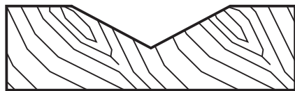
№6 ширина 30 мм; глубина 8 мм.
