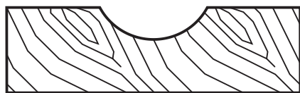
№5 ширина 20 мм; глубина 6 мм.
