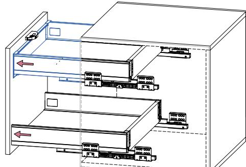
Расположите КЛИК SBH100 по центру фасада относительно верхней линии внутреннего ящика в соответствии со схемой
