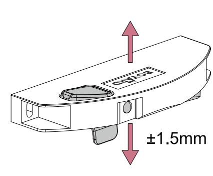
Для того, чтобы отсоединить внутренний ящик, нажмите на кнопку. После того, как зацеп вошел внутрь корпуса, внутренний ящик беспрепятственно можно сдвинуть.
